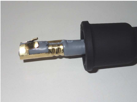
3、コネクタ金具を被せ、後部をカシめる。カシメ工具がないときは、ラジオペンチ、プライヤなどでなるべく 小さく丸める 。金具の先端はやや開いておく。
